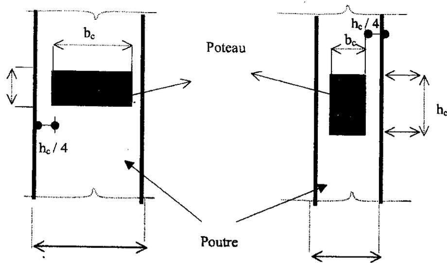
Figure 7.2 : Position poteau-poutre      Figure 7.3 : Excentricité des axes poteau-poutre
