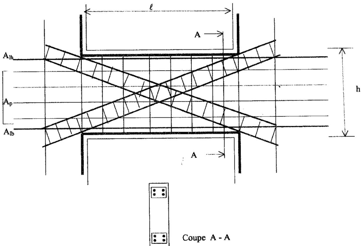
Figure 7.9 : Ferrailage du Linteau
